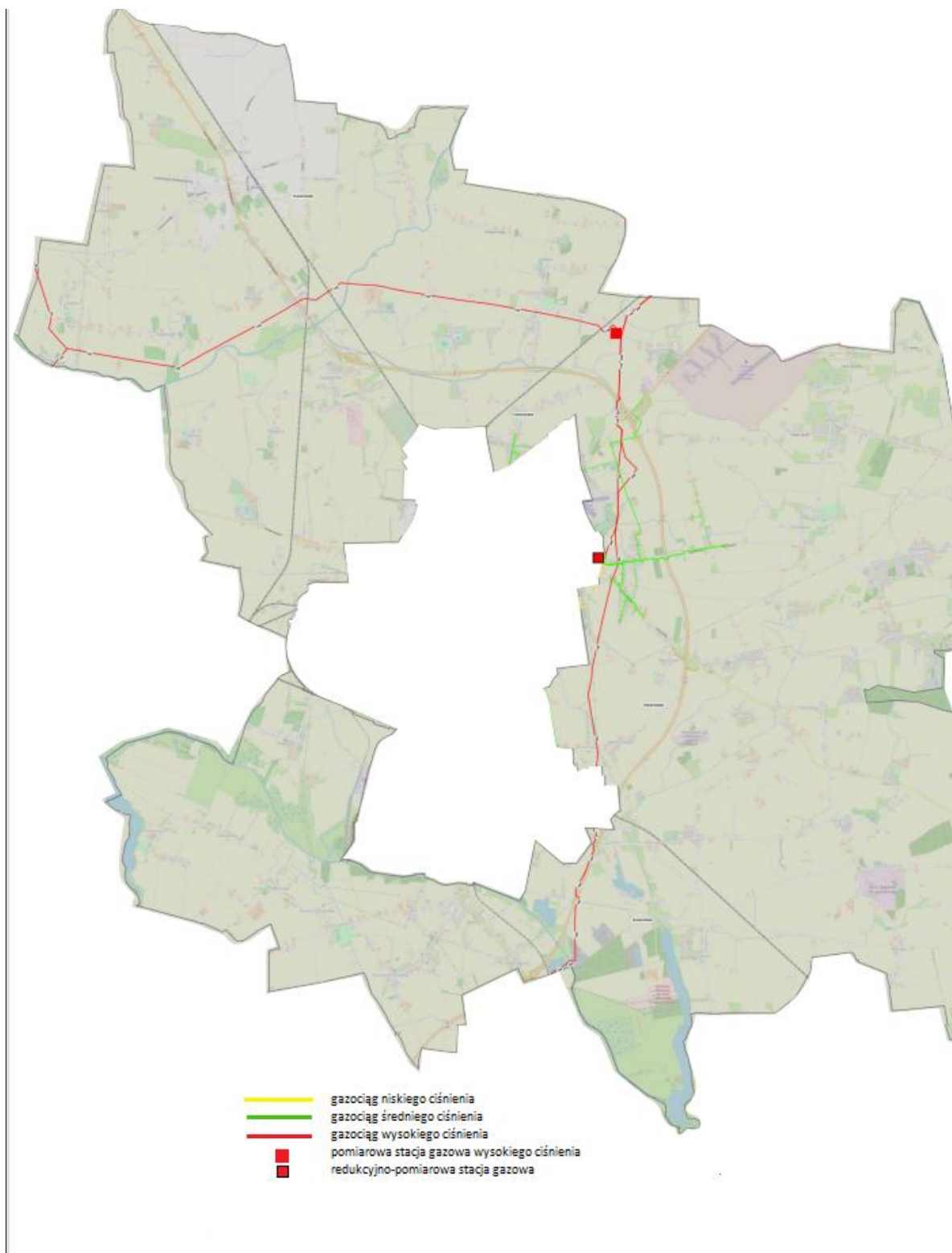
Rys. 3. Mapa sieci gazowej na terenie gminy Inowrocław źródło: PSG Sp. z o.o.
